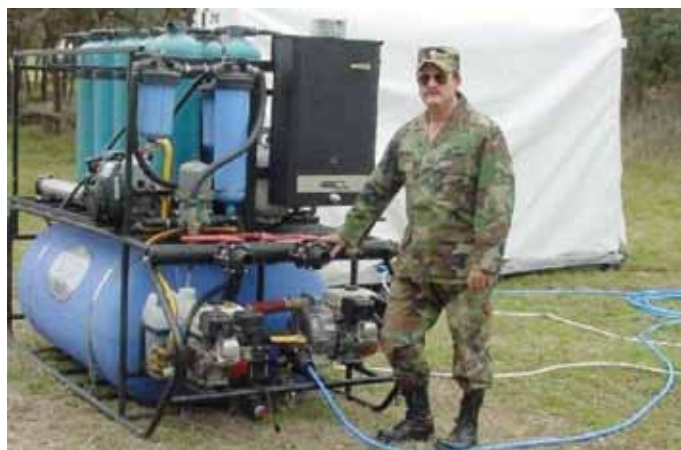
Impianto mobile per bio decontaminazione Mix mobile system for biodecontamination
