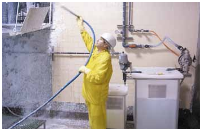
MIXI V utilizzato per produrre schiuma sgrassante MIXI V used for produce degreasing foam
