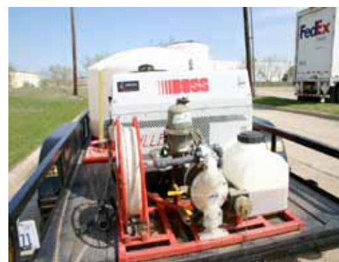
Impianto mobile di generazione schiuma estinguente Mobile fire fighting foam generator
